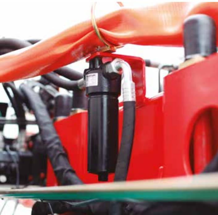
Localizado entre a bomba e o comando do guindaste, o Filtro de Alta Pressão tem a função de proteger o circuito hidráulico contra impurezas, aumentando a vida útil do equipamento e propiciando menor número de horas paradas para manutenção.
