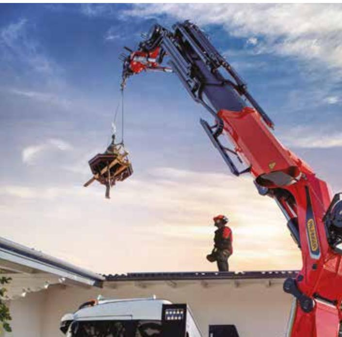
Devido a geometria dos guindastes do tipo "canivete", as operações podem ser realizadas com um giro de até 420°, trazendo maior flexibilidade e otimização da operação.
