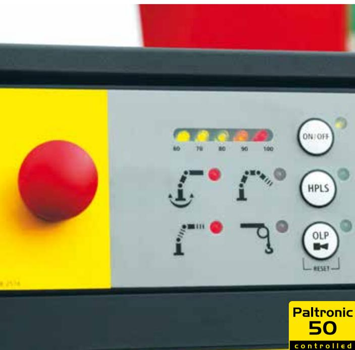
O Sistema de Proteção contra Sobrecarga não permite que a capacidade máxima de carga do guindaste seja ultrapassada.
