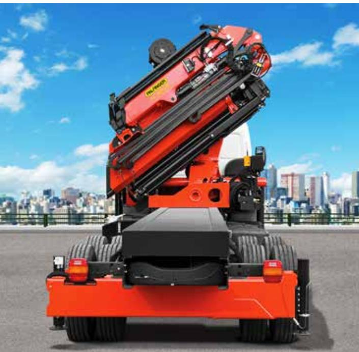
Devido ao seu design diferenciado, os guindastes do tipo "canivete" apresentam peso centralizado quando transportados, distribuindo uniformemente o peso sobre os dois lados do caminhão.
