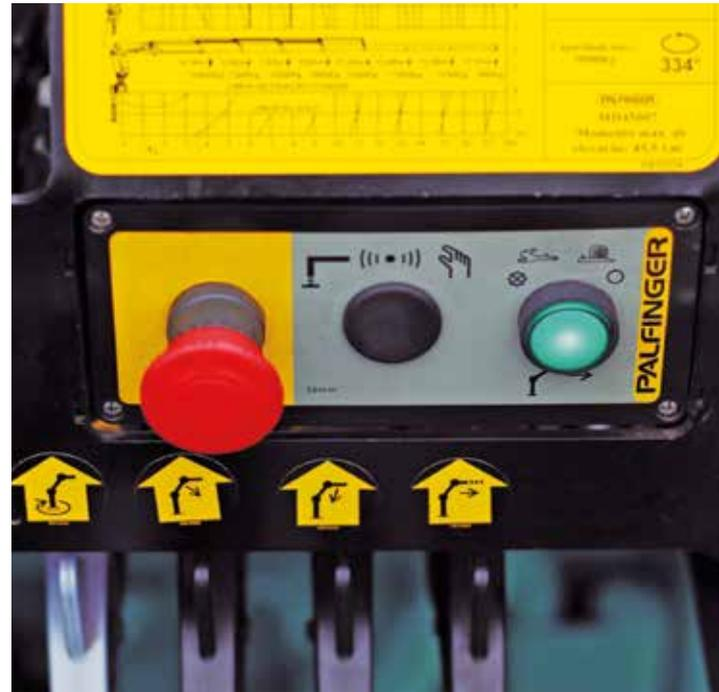
A Parada de Emergência é um botão que o operador pode acionar em situações de perigo, bloqueando todas as operações e garantindo a segurança. De acordo com a NR12, toda a máquina ou equipamento deve estar equipado com este item. Este recurso é também exigido na norma NBR14768.
