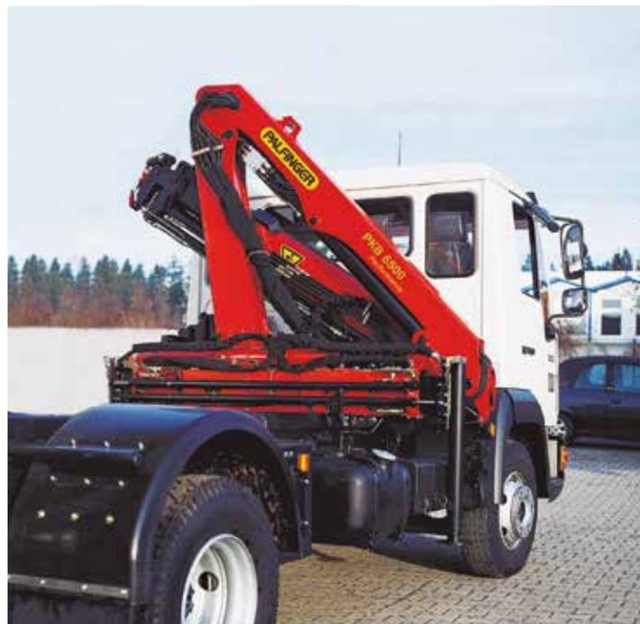
Os guindastes do tipo "canivete" possuem suas lanças em posição de transporte como a da figura acima, não havendo possibilidade de, em caso de falha, as lanças atingirem o solo durante o transporte do veículo.
