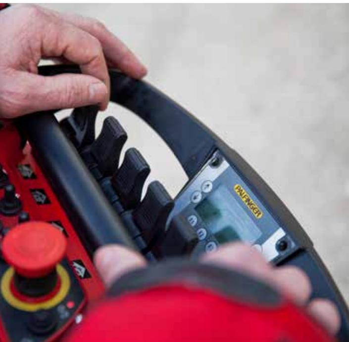
O controle remoto da PALFINGER possui doze frequências de rádio distintas. Isso permite a operação de mais de um guindaste no canteiro de obras e impede que um operador movimente por engano outro equipamento. A troca de frequência é automática.
