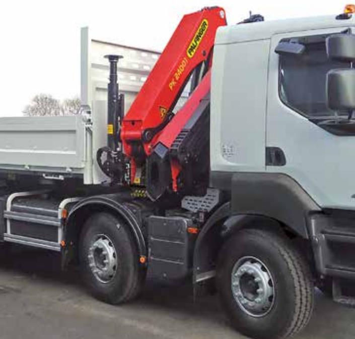
Sabemos que o cilindro de estabilização é uma das partes mais críticas na instalação do guindaste, visto que é difícil encontrar um espaço para acomodá-los no chassi do caminhão.
