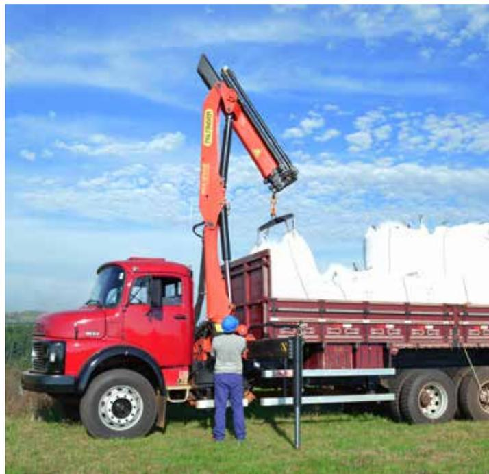
Devido a sua forma construtiva, os guindastes do tipo "canivete", realizam facilmente as movimentações próximo ao berço da carroceria, como por exemplo em aplicações com pallets e bags. Isto resulta no aproveitamento máximo de espaço da carroceria.
