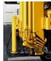
A figura ao lado, mostra a posição das lanças em um guindaste do tipo "trave". Em caso de rompimento do sistema de travamento, há risco de colisão contra o solo, causando graves acidentes.
